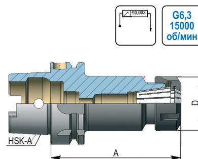
Оправка по DIN 6359 для инструмента с хвостовиком типа «Weldon» по DIN 1835B.
