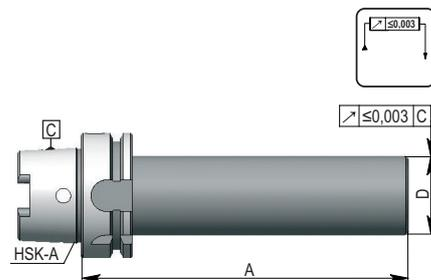
**Патрон с термозажимом для закрепления инструмента из твёрдого сплава и быстрорежущих сталей.**
