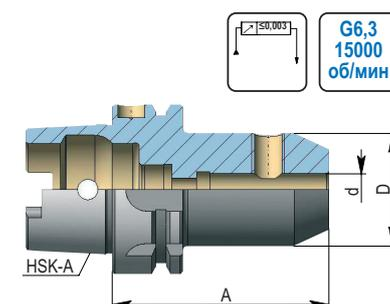
Втулка переходная для инструмента с хвостовиком конус Морзе (с лапкой) по DIN 6383.
