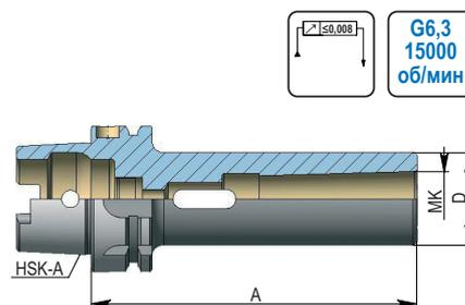
Втулка переходная для инструмента с хвостовиком конус Морзе (с винтом) по DIN 6364.
