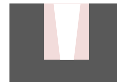
Исправление геометрии отверстий рассверливанием
