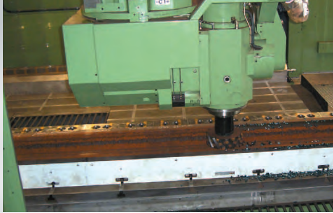
A) Fräsen der Zungen- und Backenschienen auf 2 x 24 m Länge
