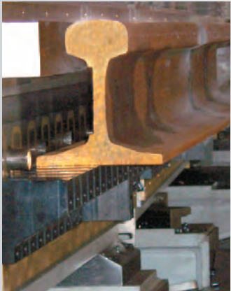
B) Schweißnahtvorbereitung der Herzstücke auf 2 x 5 m Länge
