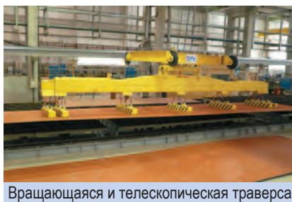
Загрузка и разгрузка листов на листорезальную машину
