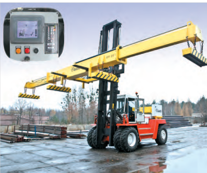
Вилочный погрузчик с телескопической траверсой, снабженной магнитным приспособлением. Генератор, установленный на погрузчике, обеспечивает электропитание магнитов.
