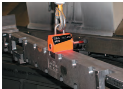
NEO 250: Загрузка/разгрузка отливки с обрабатывающего центра
