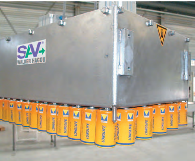
Постоянный магнит для подъема аккумуляторных батарей. Пневматическое включение/выключение магнита. Намагничивание всей площади контактной поверхности.
