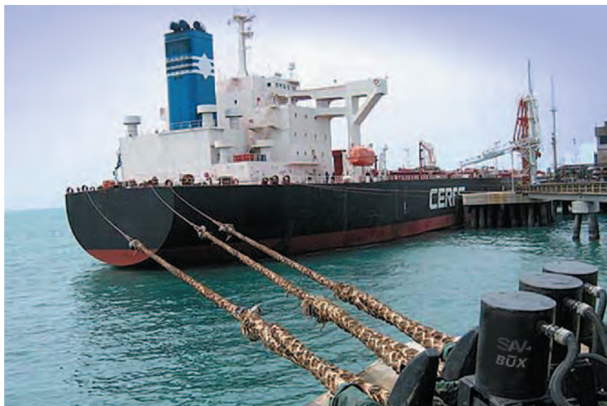
Нестандартное применение электромагнитов в порту. В аварийной ситуации магниты обеспечивают быструю отдачу швартового троса.
