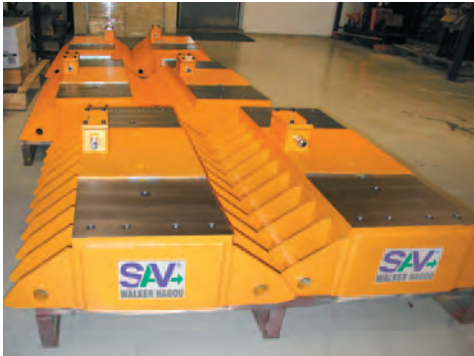
Магнитные модули специальной конструкции для позиционирования стальных листов на прокатном стане перед операцией резки гильотинными ножницами.
