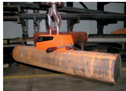
NEO 1000: Монолитный материал круглого сечения
