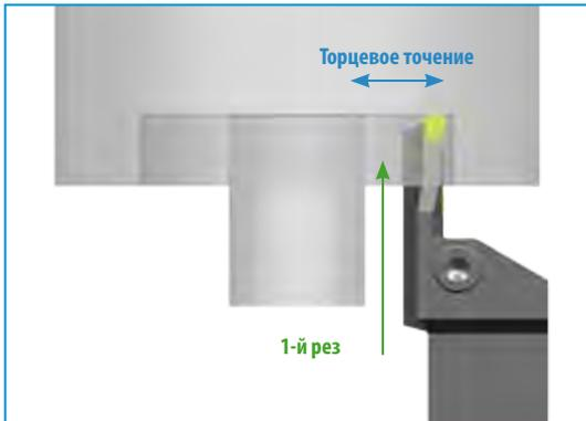
Каждая резцовая вставка подходит под определенный диапазон диаметров. Этот диапазон обозначается как  $\varnothing_{\min}$  -  $\varnothing_{\max}$ . Позиция первого реза должна находиться в пределах этого диапазона. Размер  $\varnothing_{\min}$  уменьшается на ширину режущей пластины.
