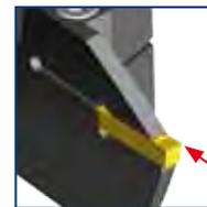
Угол режущей кромки, обращенный к наружному диаметру обрабатываемой детали.
