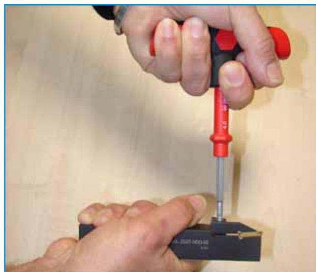
**При закреплении пластин используйте динамометрический ключ!**
