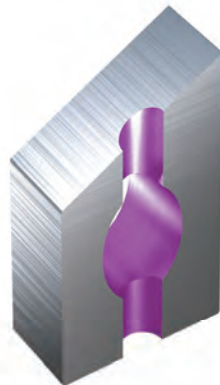
Сверление пересекающихся отверстий
