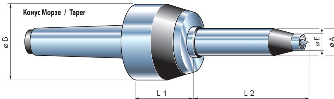
**Н**абор из вращающегося центра со сменными валами для токарной обработки дерева.
