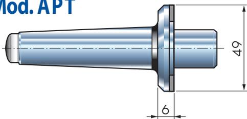
**КРЕПЛЕНИЕ ГОЛОВКИ ДЛЯ ПРОТЯЖКИ**
