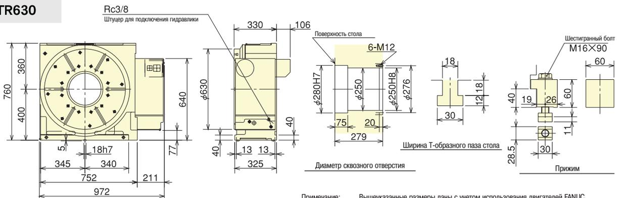
Примечание: Вышеуказанные размеры даны с учетом использования двигателей FANUC. При использовании двигателей других изготовителей, размеры могут отличаться по длине. TR-TRX – мотор расположен справа; TL-TLX – мотор расположен слева.
