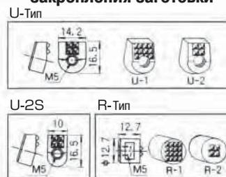
\*выбираются в зависимости от типа заготовки
