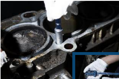
Длина 19 см. Диапазон измеряемых диаметров 3-15 мм.
