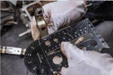
Быстрая проверка перпендикулярности измерительной ножки
