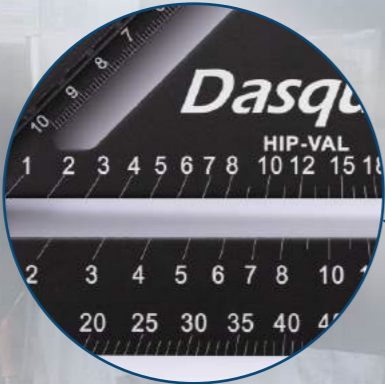
С помощью шаблона можно выбрать сверла правильного размера
