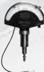
Прецизионный щуп Millimes, сконструированный в 1937 году. Первый индикаторный прибор для измерения отклонения от заданных размеров с ценой деления 1/1000 мм
