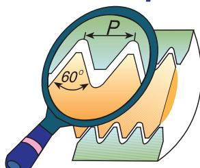
Одна пластина для наружной и внутренней резьбы
