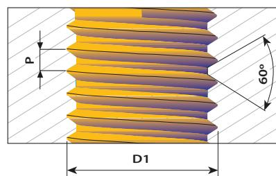
Глубина обработки до  $2 \times D_1$
