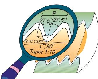
Конические резьбовые пластины выполнены односторонними и могут применяться как для наружной, так и для внутренней обработки.
