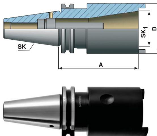
В комплект входят: крепежный винт для конусов по DIN 69871 и MAS 403 BT, а так же винт для конусов по DIN 2080
