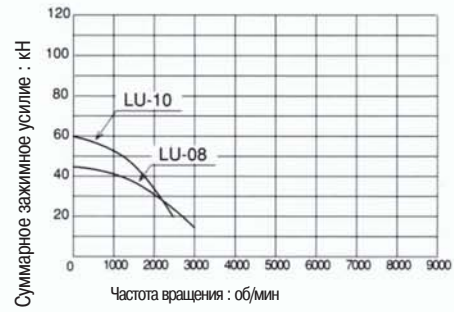
Диаграмма зависимости зажимного усилия от частоты вращения LU
