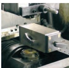
Применение на электроэрозионном вырезном станке.
