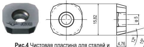
Рис.4 Чистовая пластина для сталей и чугунов. Усилия резания на 30% ниже. Для использования в нежестких технических системах
