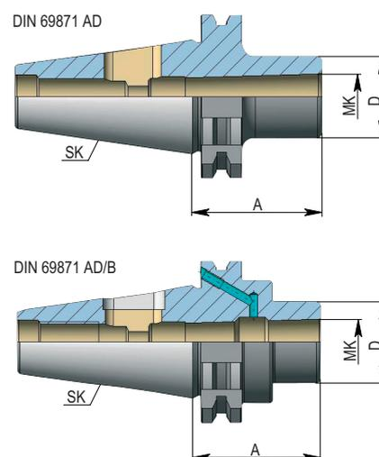
**Втулка переходная для инструмента с хвостовиком конус Морзе (с винтом) по DIN 6364.**
