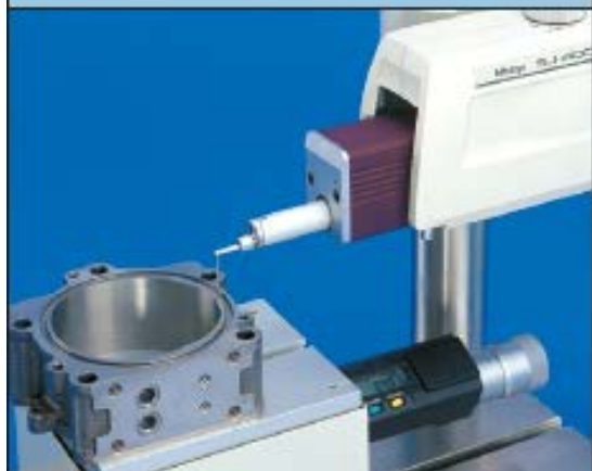
Измерение глубоких канавок
