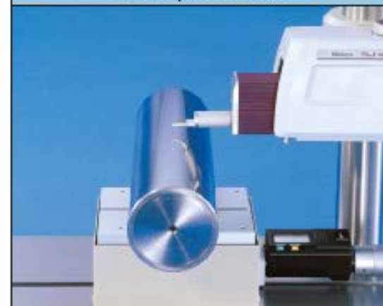
Измерение радиусных поверхностей
