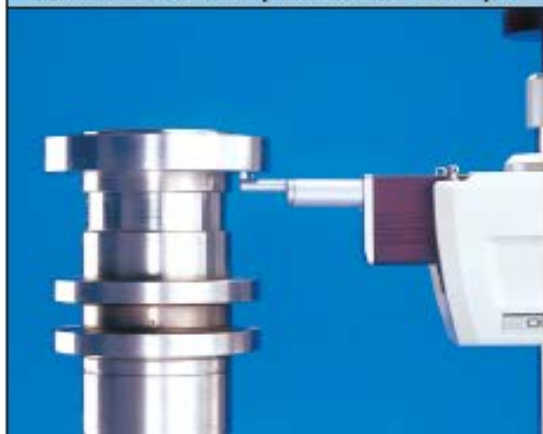
Измерение при расположении датчика в направлении вверх
