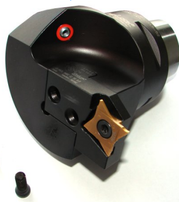
4. Установка нового картриджа (можно закрепить быстро, надежно и просто)
