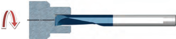
Формирование и растачивание не глубоких отверстий в сплошном материале
