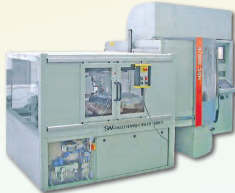
SAV-Palettenwechsler PW 1250 / 1600 mit NC-Rundtisch SAV-Palletchanger PW 1250 / 1600 with NC circular table
