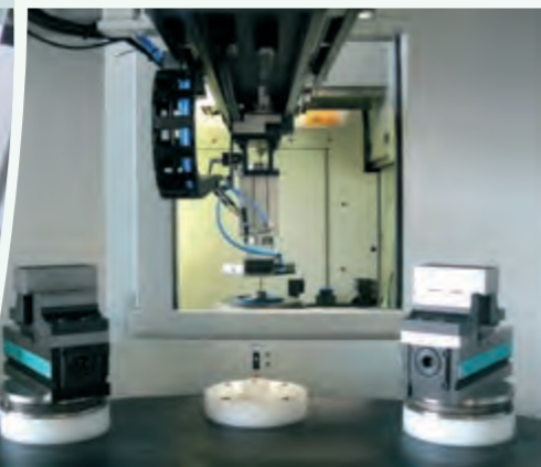
SAV-Palettenwechsler PW 1250 / 1600 mit NC-Rundtisch SAV-Palletchanger PW 1250 / 1600 with NC circular table
