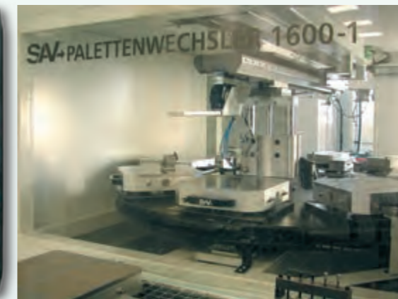
SAV-Palettenwechsler PW 1600 mit Senkerodiermaschine SAV-Palletchanger PW 1250 / 1600 with Sinker-EDM
