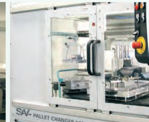
SAV-Palettenwechsler PW 1600 mit Senkerodiermaschine SAV-Palletchanger PW 1250 / 1600 with Sinker-EDM
