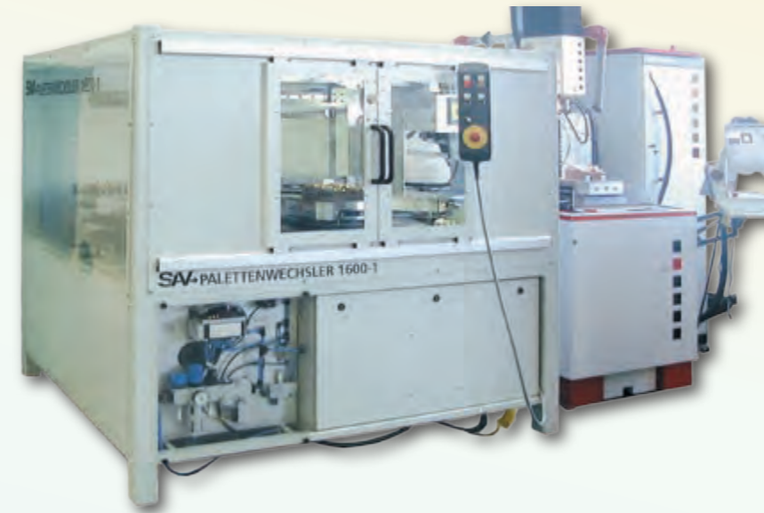
SAV-Palettenwechsler PW 1600 mit Senkerodiermaschine SAV-Palletchanger PW 1250 / 1600 with Sinker-EDM
