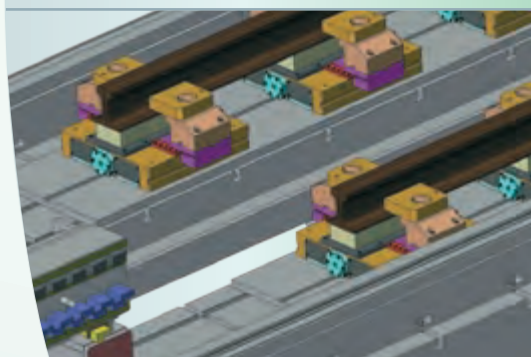
C) Fertigbearbeitung der Herzstücke Finish machining of heart sections
