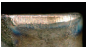
Flank wear . Freiflächenverschleiß
