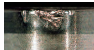
Chipping / fracture . Ausbrüche
