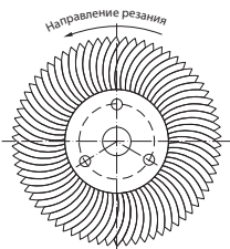
Вид насечки 4: односторонняя, насечка по периферии.
