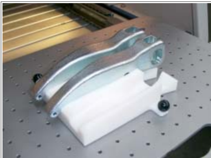
Mittels passgenauen Konturschablonen kann der Spannarm des AMF-Kraftspanners problemlos laserbeschriftet werden.
