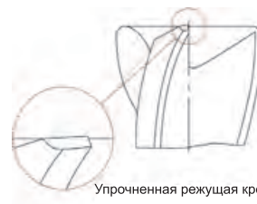
Упрочненная режущая кромка
