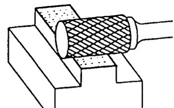
► По дополнительному заказу доступны бор-фрезы со стружколомом или с алмазной насечкой.
