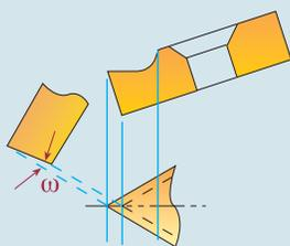
4. Профиль наружных и внутренних резьбовых пластин отшлифован с большой точностью для обеспечения точной геометрии резьбы. Пластины устанавливаются на специальные наружные и внутренние державки. Применение внутренней пластины с наружной державкой может привести к искажению установочных углов и геометрии пластины.
