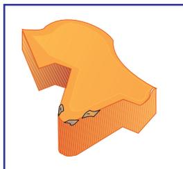
1. Используйте более прочную марку сплава
