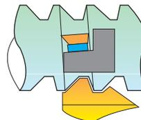
Замена стандартной опорной пластины на отрицательную исключает затирание по задней поверхности
