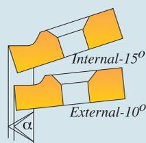
5. Пластина и державка должны быть обязательно согласованы. Например, внутренняя правая пластина может работать только с внутренней правой державкой. Несовпадение не допускается.
