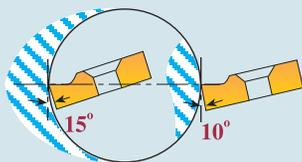
3. Геометрия посадочных мест в державках, обеспечивает при установке пластин необходимые углы наклона.
