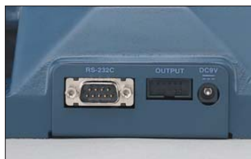
Стандартный порт вывода данных DIGIMATIC и RS-232-C
