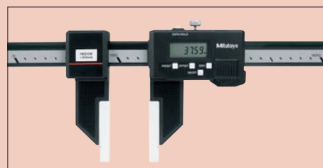
Пример использования: обе измерительные губки могут перемещаться
