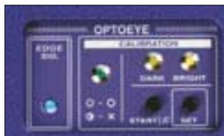
Встроенная система автоматического определения кромки
