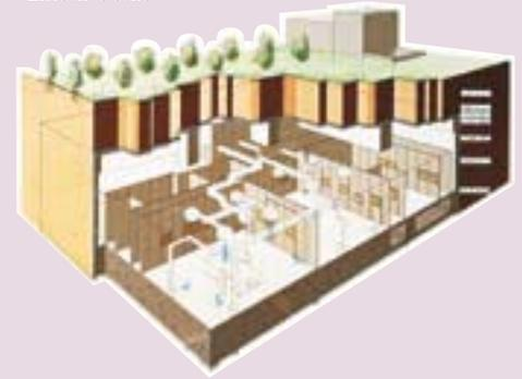
Компания Mitutoyo является единственным производителем в Японии, который имеет подземный завод по производству цифровых систем измерений длины "Linear Scale". Это завод защищен от температурных и сейсмических воздействий. Производство осуществляется в идеально стерильных условиях (степень чистоты 100). Поэтому все элементы и комплектующие приборов, которые производятся на этом предприятии остаются незагрязненными и не содержат даже микроскопических частиц.
