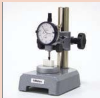
Измерительная головка № 2044 SB закреплена в измерительной стойке № 7002 М
