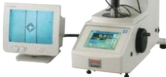
810-353D с камерой и монитором (дополнительные принадлежности)
