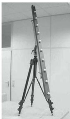
**4. КОВА-Sphere beam:** эталон из жестко посаженных керамических сфер на углепластиковую основу. Температурный коэффициент линейного расширения этого материала равен  $0,5 \cdot 10^{-6} \text{ K}^{-1}$ . Идеально подходит для калибровки среднегабаритных КИМ и ручных КИМ типа «рука». Изготавливается размерами от 1500 до 2500 мм с шагом между сферами 100 мм.
