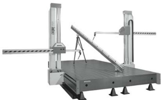
**6. KOVA-Ball Bar:** ряд сфер, скрепленных между собой распорными трубками строго откалиброванной длины. Базирование трубки по сфере происходит всегда по трем точкам, что определяет постоянство расстояний между сферами. Трубки изготавливаются из CFK углеродного пластика для уменьшения температурного влияния окружающей среды.
