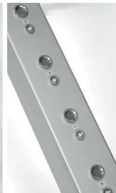
жесткий щуп КИМ базируется плотно по конусу и снимается размер. Размерная линейка эталонов от 1000 до 2500 мм.
