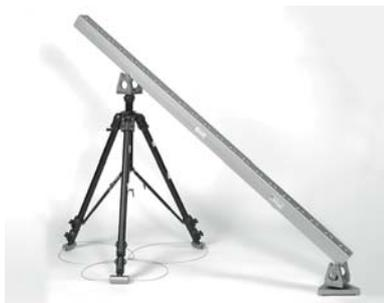
**5. КОВА-Cone Bar:** ряд конических углублений двух типоразмеров, расположенных на углепластиковой основе. Применяется эталон для проверки и калибровки КИМ типа «рука» и лазерных трекеров. Работает эталон следующим образом: измерительный
