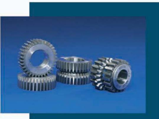
Данные накатники применяются для формирования методом пластической деформации конического сечения на зубьях синхронизирующих колец (замка) для исключения самопроизвольного выключения передачи.
