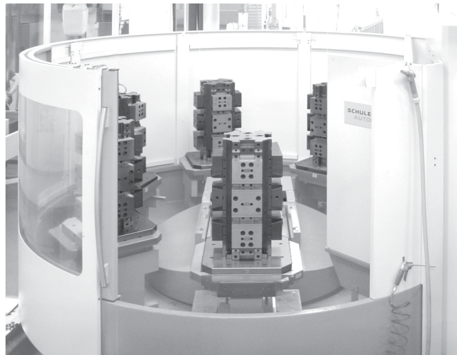
CUBIMORSA su sistema di pallet a giora per centri di lavoro VISE TOWERS assembled on round transpallet system for machining centers CUBES-ETAUX sur un centre d'usinage à palettes rotatives SCHRAUBSTOCKTURM in einem automatischen Palettenwechsler
