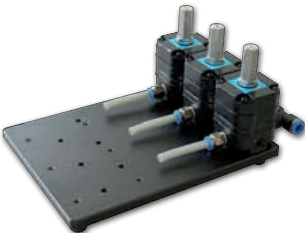
Этот модуль вырабатывает из давления воздуха прим. 5 бар, необходимое для эксплуатации пневмо-электронных преобразователей давление 2 бар. Так как это давление должно быть максимально постоянным, при эксплуатации пневмо-электронных преобразователей 1940 фирмы Mahr, предписано использование чувствительных редуцирующих клапанов.
