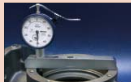
Индикаторный глубиномер № 7221 с измерительной головкой и основанием
