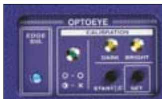
Встроенная система автоматического определения кромки
