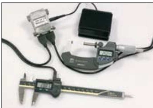
Пример использования с ножным переключателем (приобретается дополнительно)
