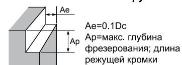
Рис.3 Фрезерование уступа с большим вылетом инструмента
