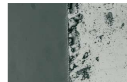
Vergrößerung 500 x: CVD-Dickfilm-Diamant, Laserbearbeitung Magnification 500 x: CVD-Thickfilm-Diamond, Laser processing
