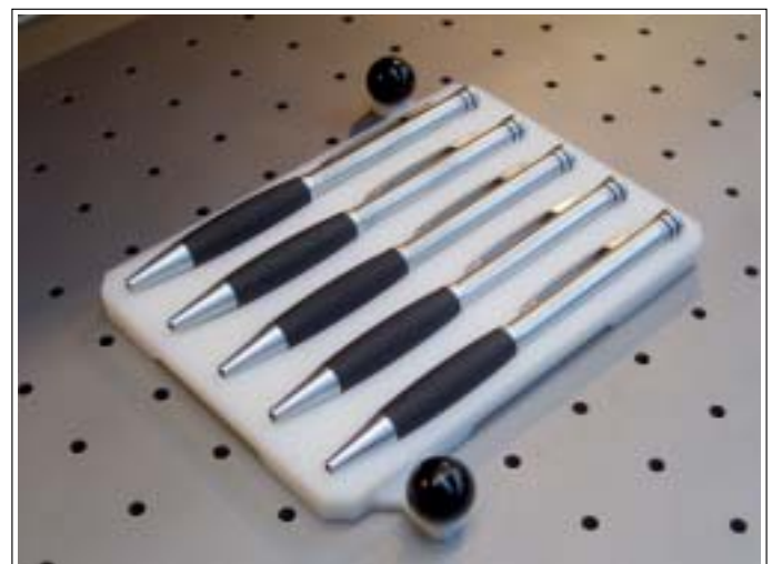
Kugelschreiber oder andere Werbegeschenke mit komplizierten Außenformen können mit Konturschablonen passgenau positioniert werden.
