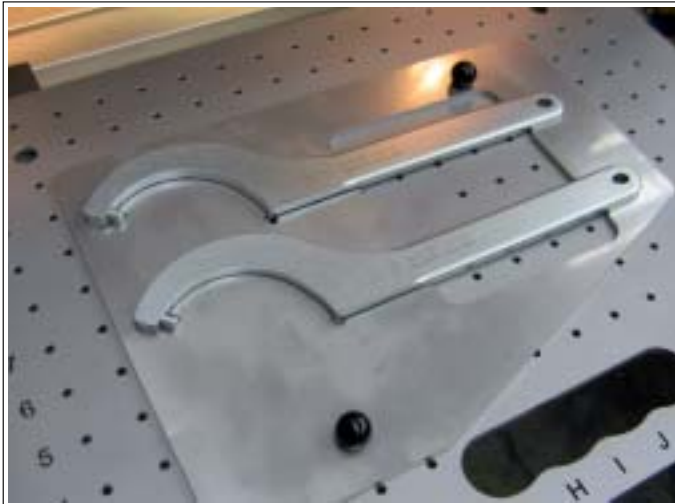
AMF-Hakenschlüssel DIN 1810BD können mittels Konturschablonen problemlos in Serie beschriftet werden.
