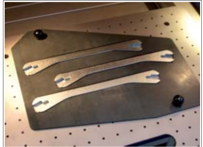
Eine exakte Beschriftung von Sonderschlüsseln ist durch das Positionieren mittels Konturschablonen gewährleistet.
